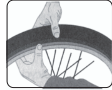
FIGURE C replace tyre onto rim.
