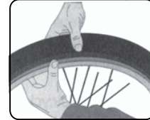
FIGURE C replace tyre onto rim.
