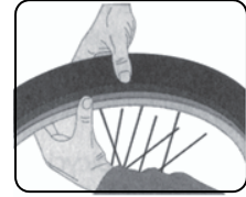
FIGURE C replace tyre onto rim.
