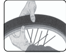
FIGURE C replace tyre onto rim.
