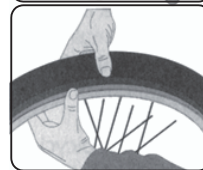
FIGURE C replace tyre onto rim.
