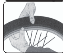
FIGURE C replace tyre onto rim.
