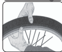
FIGURE C replace tyre onto rim.
